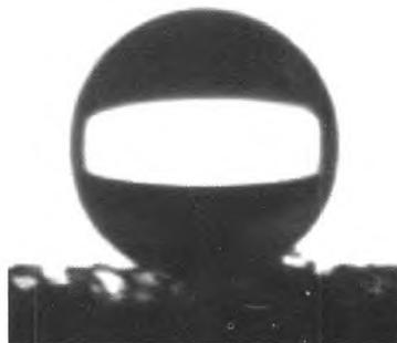
图 1 超疏水聚硅氧烷/聚氨酯海绵与水的接触角
