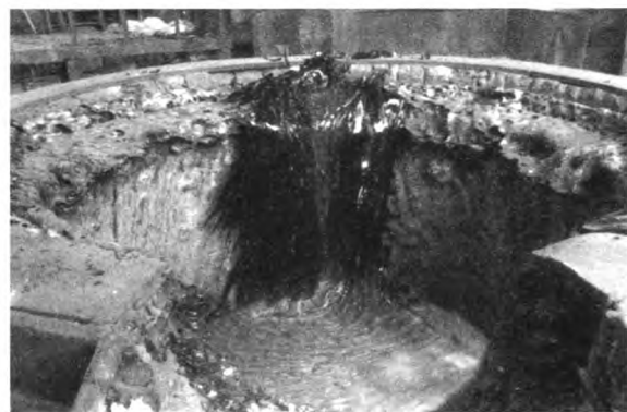
图 2 熔渣流到钢包内的状态图 Fig. 2 Slag flow to the ladle
