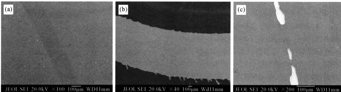
图 5 DLC 薄膜在摩擦试验后的形貌图 (a)干摩擦;(b)水润滑;(c)少量润滑油
