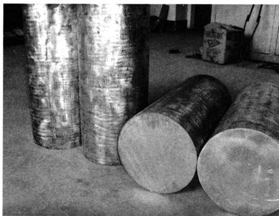
图 2 直径 300 mm 的 ZK60 镁合金圆棒
