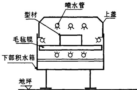
图3 喷水系统断面图
