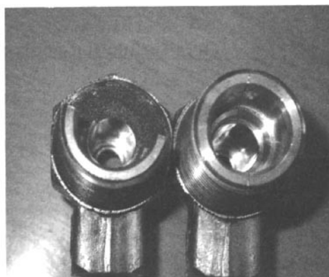
图 1 阀体断裂形貌
