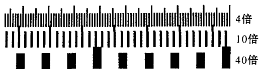
图 2 不同物镜放大倍数下的标尺刻度
