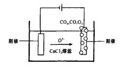
图 1 FFC 法示意图 Fig. 1 Schematic diagram of FFC process
