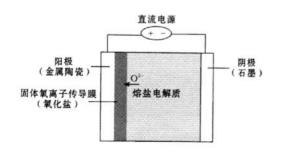
图 4 SOM 法工艺示意图 Fig. 4 Schematic diagram of SOM process
