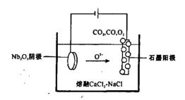
图 3 改进的 FFC 法示意图
