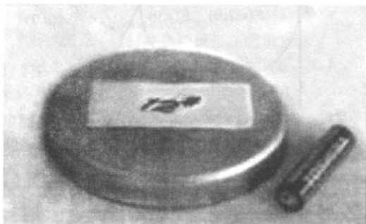
图 10 通过简单拉深旋压成形的椭球形工件 Fig. 10 The elliptical workpiece of simple drawing spinning
