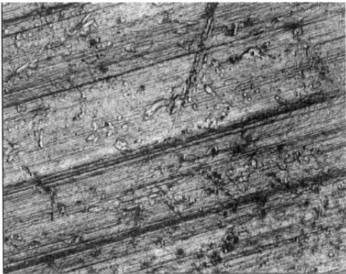
图 4 冶金层磨粒磨损形貌
