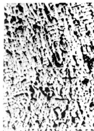
Рис. 6 Микроструктура сплава Cu-36 вес % Pb; исходное состояние, \times 100 \times 4
