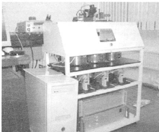
Рис. 7 Экспериментальная установка для селективного лазерного спекания
