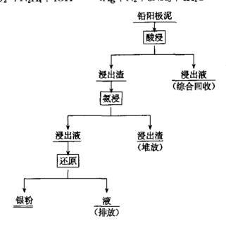
图 1 回收银的工艺流程
