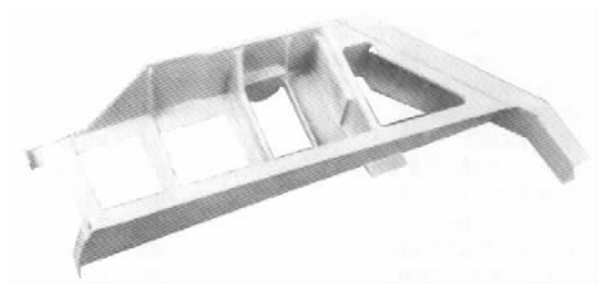
图2 腹鳍前接头铸件
