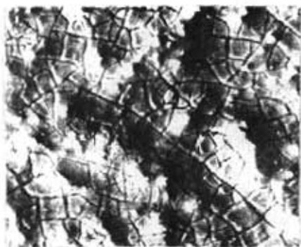
图 1 \text{RuTi} 涂层二次电子像(SEI), 1000\times
