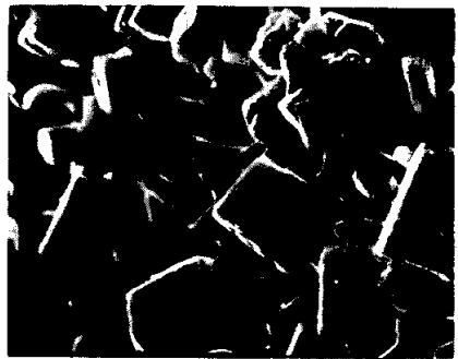
图 11 人造金红石的扫描电子显微镜二次电子图像,4500×
