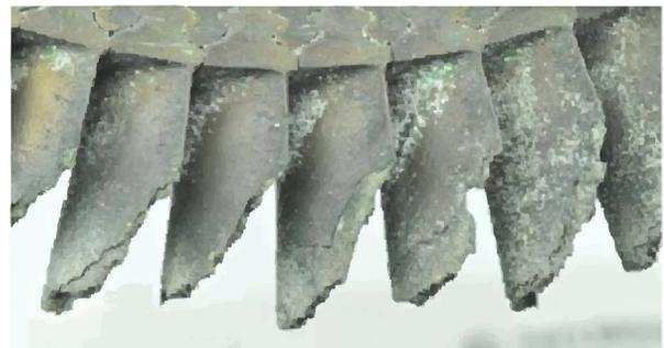
图2 发动机中的热腐蚀形貌<sup>[8]</sup>
