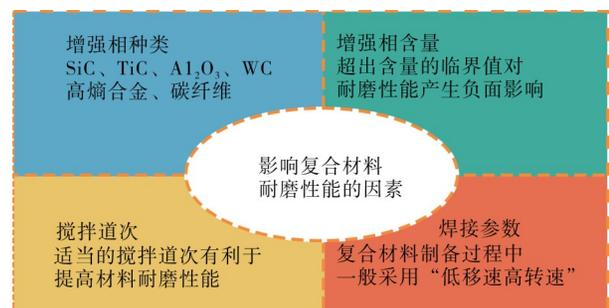
图 6 影响复合材料耐磨性的因素<sup>[39-40]</sup>
