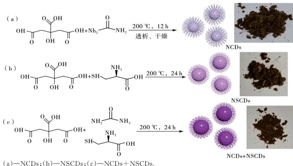
图1 3种掺杂碳点的合成示意图
