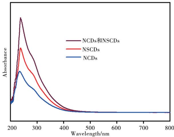
图5 碳点的紫外-可见光谱(UV-vis)测试
