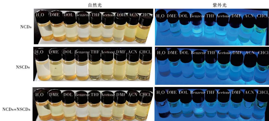
图7 碳点在不同配体中在自然光照(左)和在365 nm紫外灯下的显示光学照片
