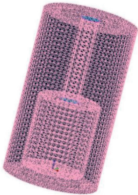
图 3 铸件和铸型面网格示意图
