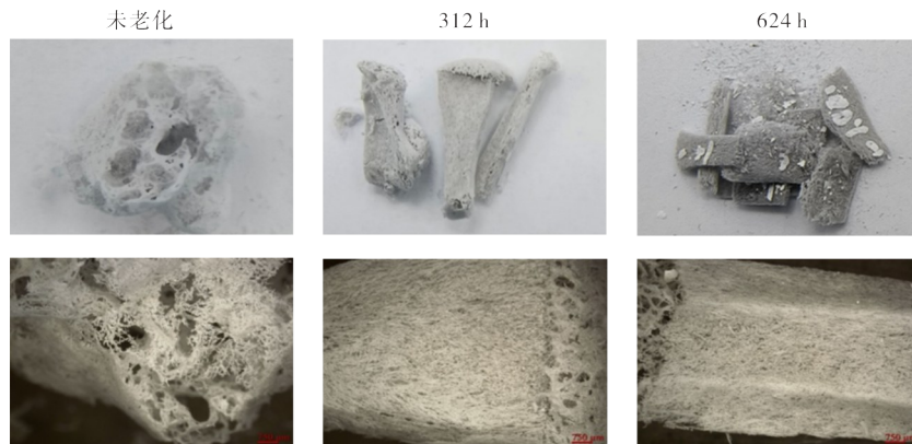
图4 180℃热氧老化前后样条灰分外观形貌
