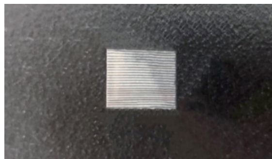
图 3 切割抛光的 Ti/Al 3 Ti 层状复合材料
