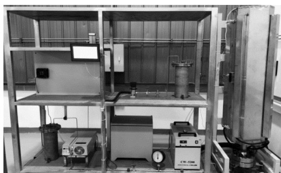
图1 超临界二氧化碳腐蚀试验平台 [27]
