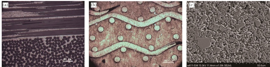
图2 “三明治”结构复合材料中几种组成部分的金相照片 (a) 2D-M40 f /5A06+Al; (b) 2D-M40 f +2D-Ti f /5A06; (c) TiB 2 /2024+Al
