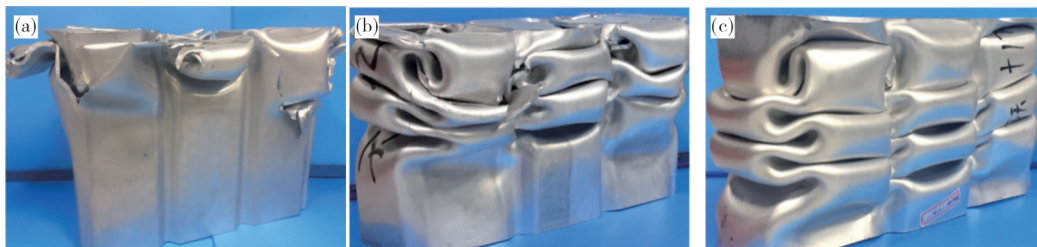
图2 不同时效状态下Al-5.9Zn-0.8Mg合金型材进行压溃实验后的宏观照片
