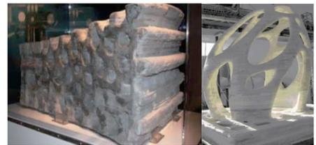
图 1 D-shape 工艺打印出的结构件
